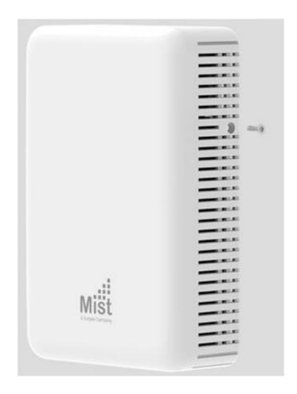
AP12 の側面には開封防止のため セキュリティネジ (T8) が取り付けられています
